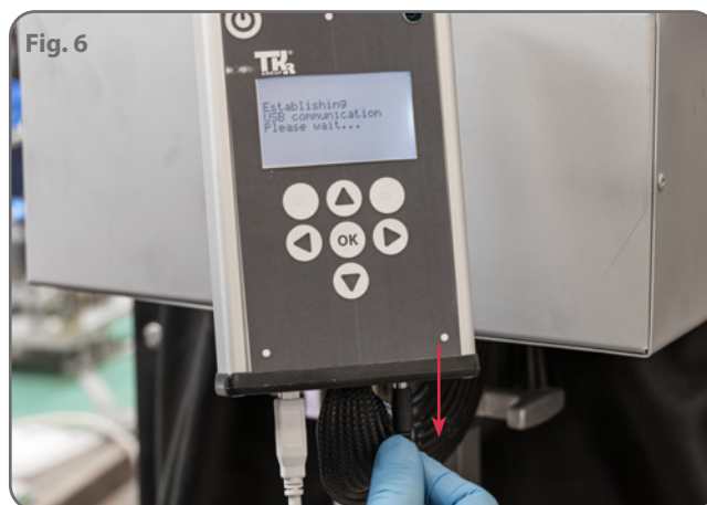
Fig. 6 Transfert du fichier de mise à jour au module de commande
